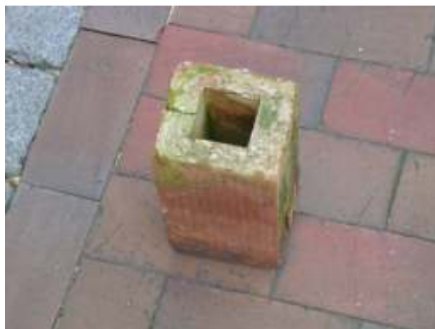
Vorhandener Hintermauerstein mit ungewöhnlichem Hohlraumquerschnitt
